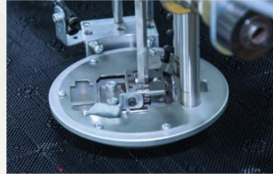
AKILLI BIÇAK SİSTEMİ ACCURATE CUTTING WITH INTELLIGENT KNIFE SYSTEM Kesimi zor olan kumaşlarda Kot/ Dokuma Kumaş), ve yüksek katlarda meydana gelen sapmaları algılar ve bu sapmaları telafi etmek için bıçak açısını değiştirir. Sonuç olarak daha hassas ve düzgün kesilmiş bir kesim. Senses deflection of the knife caused by cutting difficult materials or high-ply spreads and changes the knife angle to compensate for this deflection. This results in more accurately cut parts and makes it possible to nest parts closer together to achieve outstanding material utilization
